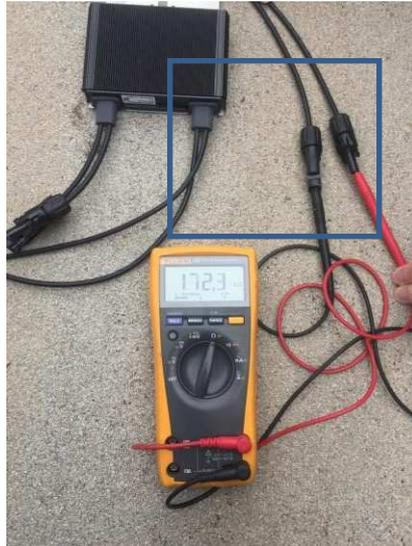
4. **In assenza di diodi guasti:** misurare la Voc del modulo e confrontare i risultati con la scheda tecnica del modulo (un valore diverso indica la presenza di un problema con il modulo).
