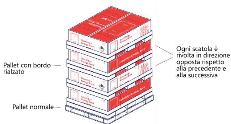
Figura 1: Pallet imballato per la spedizione con un massimo di quattro scatole di batterie 400V SolarEdge Home
